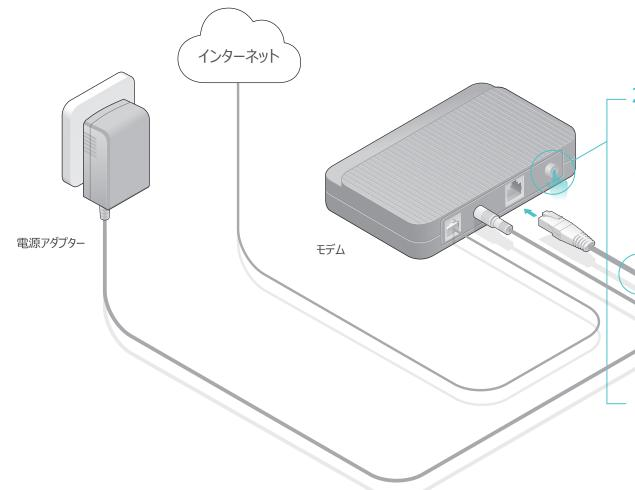
2 モデムの電源を切って、バックアッ プ バッテリがあれば取り外します。
