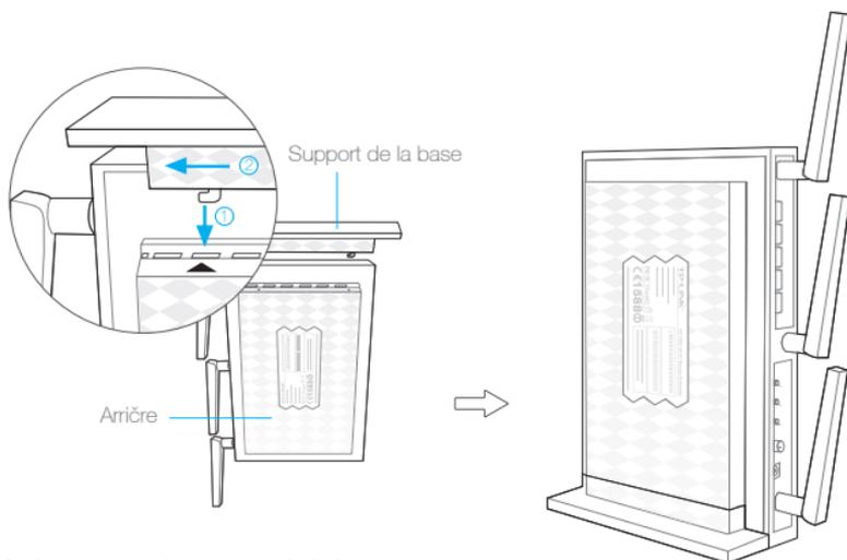
Munissez-vous du support de la base fourni, insérez les attaches dans les fentes avec les ▲, puis poussez-le vers la gauche.
