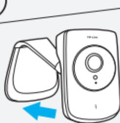
Coloca la cubierta de la base y la cabeza de la cámara de nuevo.
