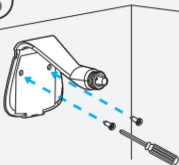
Utiliza dos tornillos para fijar la base.
