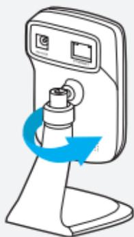
Desenrosca el cabezal de la cámara.
