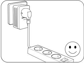
Pour profiter complètement de la fonction filtre de l'adaptateur CPL et pour améliorer les transmissions de données dans le réseau, utilisez la prise femelle intégrée de l'adaptateur CPL pour y connecter une prise multiple si nécessaire.
