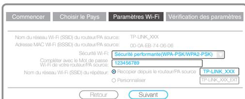
c. Compléter le champ avec le **mot de passe** du réseau **Wi-Fi** de votre point d'accès ou routeur. Le SSID (**nom du réseau Wi-Fi**) généré par votre TL-WA850RE peut être la copie de celui de votre point d'accès ou routeur (**TP-LINK\_XXX**) ou être différent (**TP-LINK\_XXX\_EXT**) si vous cliquez sur **Personnaliser**. Cliquer ensuite sur **Suivant**.
