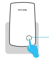
⌚ La DEL 'RE' va passer de l'état clignotant à l'état fixe dans les 2 minutes, indiquant que la connexion via WPS a réussi. Patientez jusqu'à ce que plusieurs DELs indiquant la 'force du signal' s'allument.
