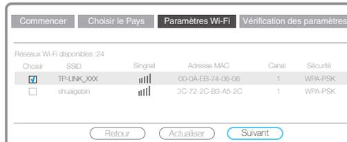
b. Sélectionner le réseau **Wi-Fi** de votre point d'accès ou routeur, par exemple : **TP-LINK\_XXX**. Cliquer ensuite sur **Suivant**.
