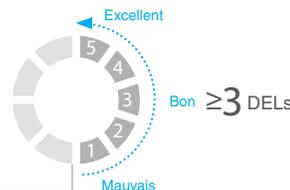
Vérifier que le répéteur est situé à un emplacement avec au moins **3 DELs de force de signal allumées** pour garantir de bonnes performances.
