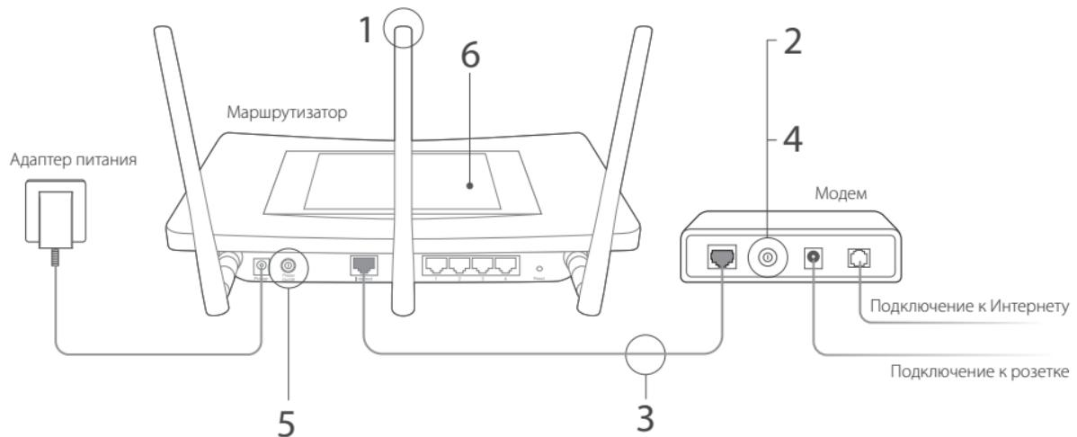
**1** Установите антенны в вертикальном положении. Если антенны уже установлены, перейдите к следующему шагу.
