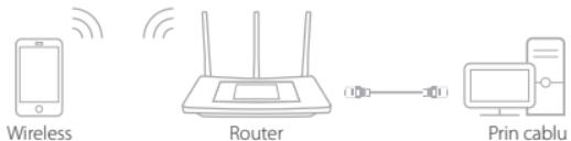
**Notă:** Dacă nu ati modificat SSID-ul și parola în timpul configurării, utilizați SSID-ul implicit și parola imprimată pe spatele routerului pentru a vă conecta la rețeaua wireless.
