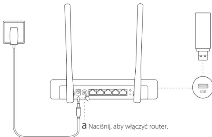
**b** Podłącz do routera modem USB 3G/4G z kartą SIM/UIM.
