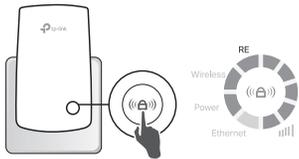
El LED de RE debería cambiar de parpadeante a sólido encendido, lo que indica una conexión exitosa.
