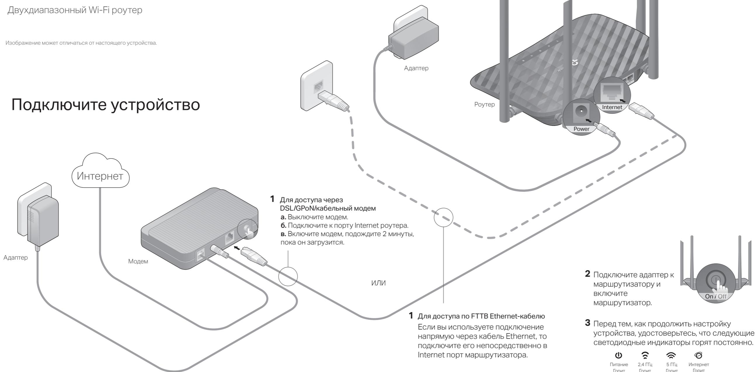
**1** Для доступа через DSL/GPON/кабельный модем
