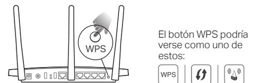
2. En 2 minutos, presione el botón WPS en el extensor durante 1 segundo. El LED debería cambiar de parpadeante a sólido encendido, lo que indica una conexión exitosa.
