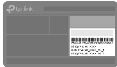
Le réseau sans fil par défaut (SSID) et mot de passe sont imprimé sur l'étiquette en bas du routeur.
