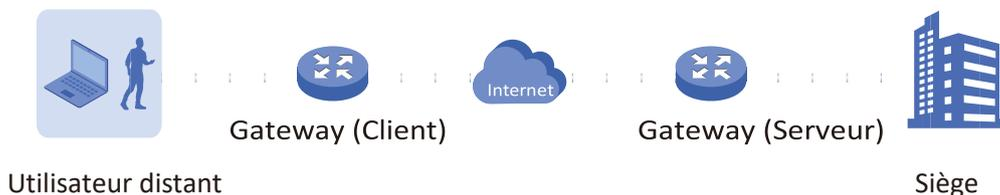
Lorsque l'ordinateur portable ou le PC de l'utilisateur distant fonctionne comme le client VPN, l'ordinateur portable ou le PC utilise un logiciel client VPN pour créer des tunnels VPN entre lui-même et le serveur VPN. Le logiciel client VPN peut utiliser L2TP, PPTP, IPsec ou OpenVPN comme protocole de tunnelage.
