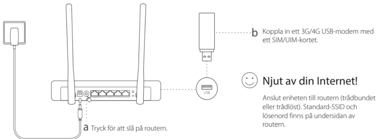
Anslut enheten till routern (trådbundet eller trådlöst). Standard-SSID och lösenord finns på undersidan av routern.
