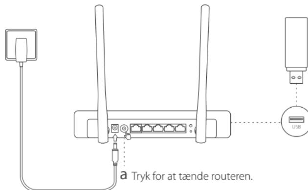
**b** Forbind et 3G/4G USB-modem med et SIM/UIM-kort.
