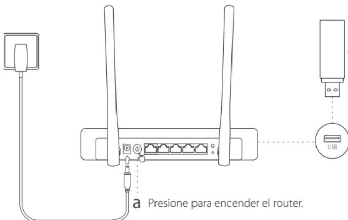
**b** Conecte un módem USB 3G/4G con una tarjeta SIM/UM.
