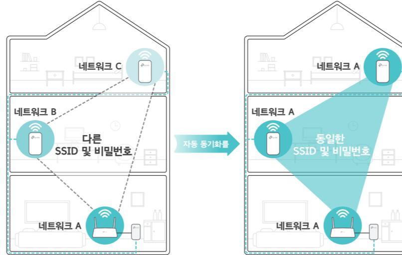
LED 일정이나 Wi-Fi 설정 및 게스트 네트워크와 같은 다른 Wi-Fi 설정을 사용하여 모든 익스텐더를 개인 설정하면 설정이 동일한 전력선 네트워크의 다른 익스텐더에도 자동으로 동기화됩니다.
