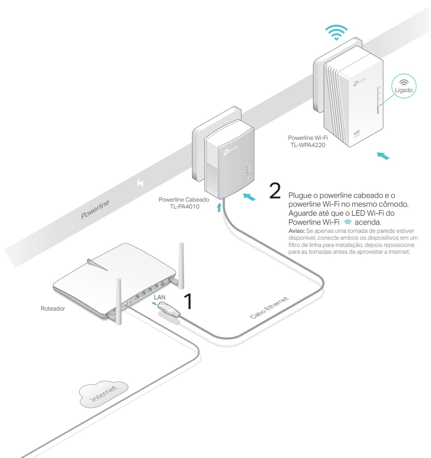
**2** Plugue o powerline cabeado e o powerline Wi-Fi no mesmo cômodo. Aguarde até que o LED Wi-Fi do Powerline Wi-Fi acenda.
