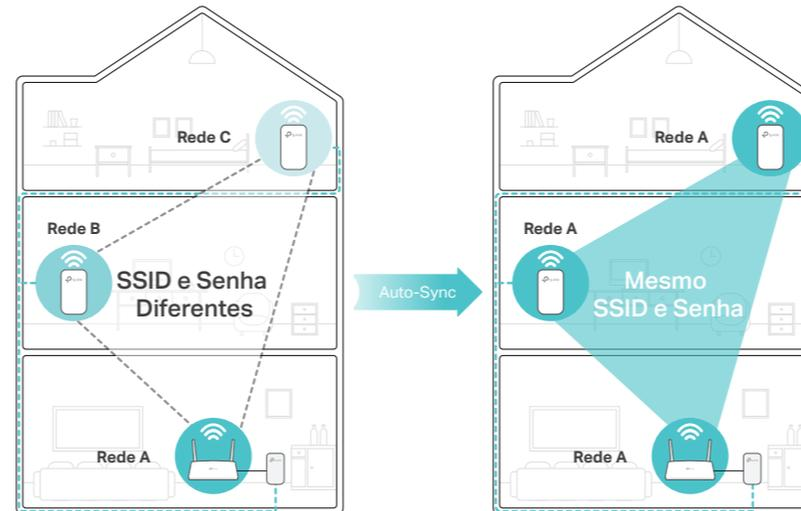
Se você personalizar qualquer powerline Wi-Fi com agendamento LED ou outras configurações Wi-Fi (como Agenda Wi-Fi e Rede para Convidados), as configurações também serão sincronizadas automaticamente com outros powerlines Wi-Fi na mesma rede elétrica.
