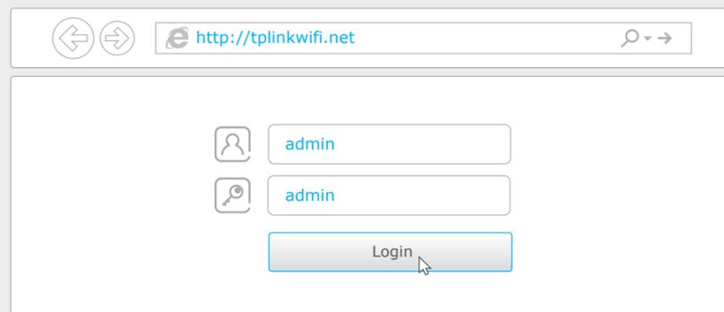
**B** Crie um novo nome de usuário e senha e clique em **Confirmar**. Siga as instruções passo a passo da Configuração Rápida para completar a configuração inicial.
