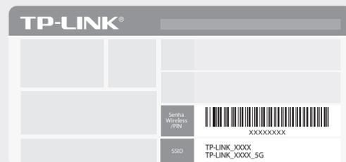
b Clique no ícone de rede do seu computador ou vá para Configurações Wi-Fi do seu dispositivo móvel, em seguida, selecione o SSID para entrar na rede.
