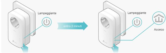
**2** Aggiungere un ulteriore powerline ad una rete sicura esistente (opzionale)
