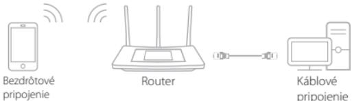
**Poznámka:** Ak SSID a heslo počas konfigurácie nebolo zmenené, použite predvolené SSID a heslo, ktoré je vytlačené na spodnej časti routera pre pripojenie k bezdrôtovej sieti.
