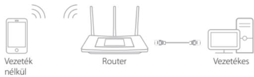
**Megjegyzés:** Ha nem módosította az SSID-t (Wi-Fi hálózat nevét) és a jelszót a konfiguráció során, használja a router alján található alapértelmezett SSID-t és a jelszót a vezeték nélküli hálózathoz való csatlakozáshoz.
