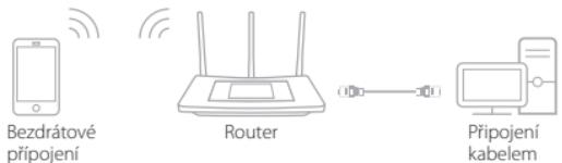
**Poznámka:** V případě, že jste neměnili SSID ani heslo během konfigurace, pak pro připojení k bezdrátové sítí použijte výchozí SSID a heslo, které je vytištěno na spodní straně routeru.
