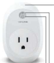
⚙️ Maintenir appuyé (environ 5 secondes) jusqu'à ce que la DEL Wi-Fi clignote (Alternance de couleurs Vert/Ambre) pour initier le process d'auto configuration.
