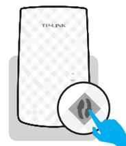
約 1 分後に、対応する LED (2.4G と 5G) が点灯したままの状態になり、WPS 接続が正常に完了したことを示します。LED が点灯しない場合は、オプション 1 を使用してください。
