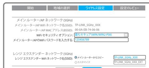
F. ワイヤレス設定を確認して [再起動] をクリックします。2.4G と 5G の両方の LED がオンになります。
