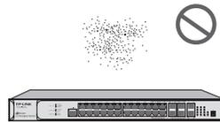
O pó acumulado sobre o switch pode ser absorvido pela eletricidade estática e resultar em mau contato dos pontos de contato de metal. Algumas medidas foram tomadas para o dispositivo evitar a eletricidade estática, mas uma eletricidade estática muito forte pode causar danos fatais aos elementos eletrônicos na placa de circuito interno. Para evitar o efeito da eletricidade estática no funcionamento do switch, preste muita atenção aos itens a seguir:
