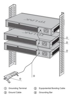
Figure 3-3 Equipotential Bonding
