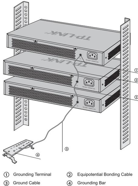
Figure 3-3 Equipotential Bonding
