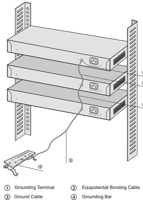
Figure 3-3 Equipotential Bonding
