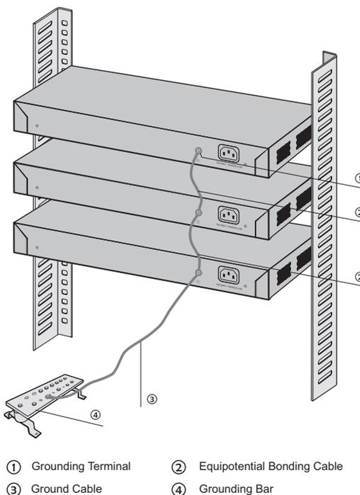
Figure 3-3 Equipotential Bonding
