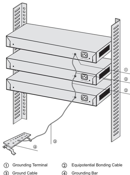
Figure 3-3 Equipotential Bonding
