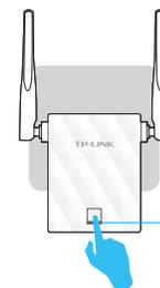
O LED deve ficar verde fixo, indicando uma conexão bem sucedida.
