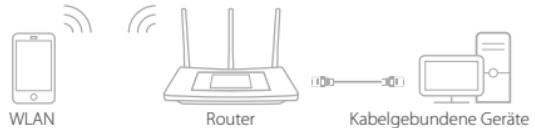
**Hinweis:** Haben Sie während der Konfiguration weder SSID noch Passwort geändert, verwenden Sie die Standard-SSID und das Standard-WLAN-Passwort, die auf der Unterseite des Routers zu finden sind, um sich mit Ihrem WLAN zu verbinden.
