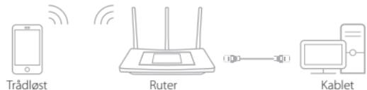
**Merk:** Dersom du ikke har endret SSID og passord under konfigurasjonen, må du bruke standard SSID og passord som er trykt på undersiden av ruteren for å koble deg til trådløst nettverk.
