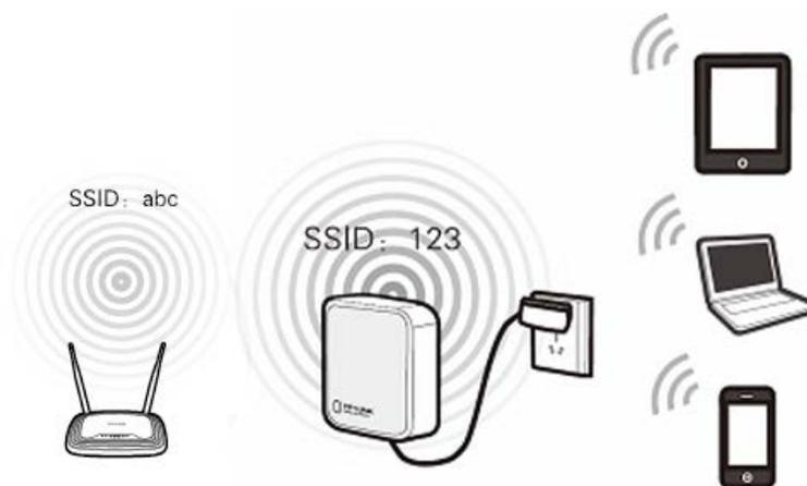
Figura 2-4 Collegamento in modalità bridge
