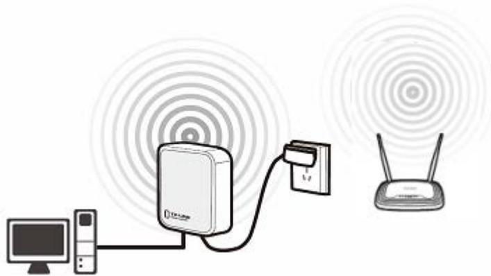
Figura 2-5 Collegamento in modalità client
