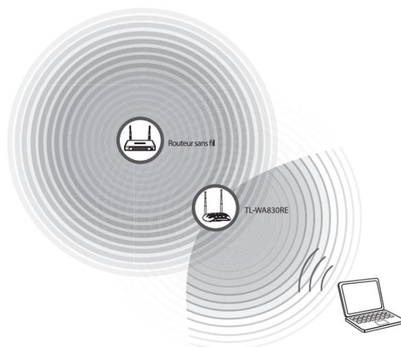
**Remarque :** Une fois la connexion établie, si vous déplacez le TL-WA830RE d'un endroit à un autre (en restant dans le rayon de portée du routeur sans fil), il se reconnecte automatiquement au réseau cible.
