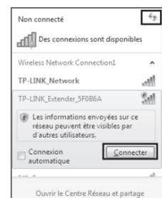
3) Lorsque **Connecté** s'affiche à côté du SSID du TL-WA830RE, cela signifie que la connexion a été correctement établie. Vous ne pourrez vous identifier que lorsque la connexion sera établie.
