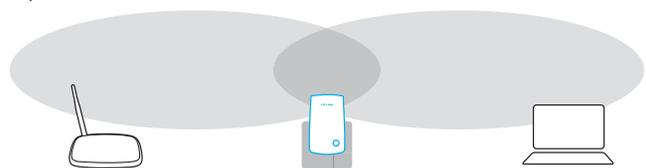
Идеальное расположение для усилителя сигнала - **посередине** между вашим беспроводным маршрутизатором и устройством с поддержкой Wi-Fi.
