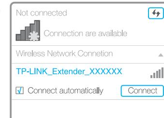
1. Отключите ваше проводное соединение. Нажмите значок **Беспроводное сетевое соединение на вашем рабочем столе**.
