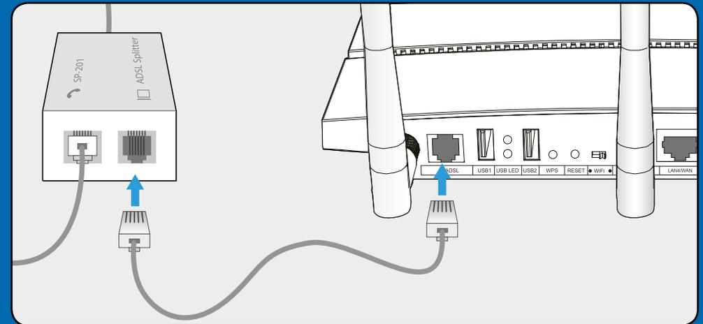
Connettere la porta **MODEM**
