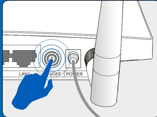
Portare il pulsante **POWER** sul pannello posteriore del modem su **ON**.
