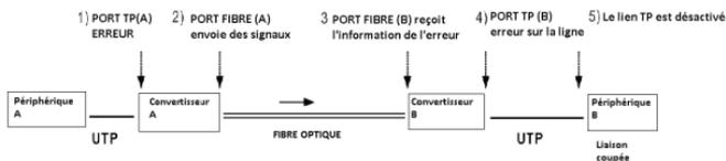
Si une erreur se produit au niveau du port TP (A), le port FX (A) envoie un signal particulier qui informe le port FX (B) de la situation.
