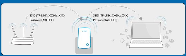
Spostate il Range Extender nel luogo della vostra casa che permette le migliori copertura e qualità di segnale. Il Range Extender si riconnetterà automaticamente al vostro Router/AP principale entro circa 30 secondi dopo che l'avrete alimentato. La collocazione ideale del vostro Range Extender è a metà strada fra il vostro Router/AP principale e i dispositivi Wi-Fi. Se possibile, collocate il vostro Range Extender in un luogo dove la corona LED mostri 3 LED di segnale.
