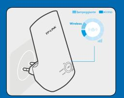
Inserite il Range Extender in una presa elettrica vicina al vostro Router/AP. Attendete fino a che i LED **Power** e **Wireless** si accendano.
