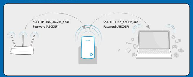
Scegliete il Nome della Rete Wi-Fi del Range Extender (**TP-LINK\_XXXXX**). Il Range Extender condivide gli stessi Nome di Rete Wi-Fi (SSID) e Password Wi-Fi del vostro Router/AP principale.
