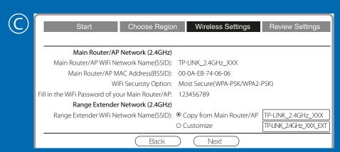
Immettete la password Wi-Fi del vostro Router/AP principale. Potete immettere il nome della rete Wi-Fi (SSID) del vostro Router/AP principale (TP-LINK\_XXXXX).
