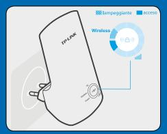
Inserite il Range Extender in una presa elettrica vicina al vostro Router/AP.
