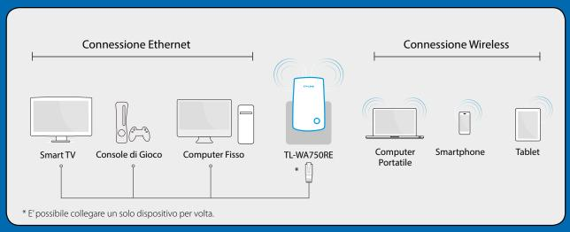
La porta Ethernet del Range Extender ne permette l'uso come scheda di rete wireless connettendola a dispositivi cablati quali lettori Blu-Ray, console di gioco, DVR e smart TV. In contemporanea il dispositivo può condividere la rete wireless.
