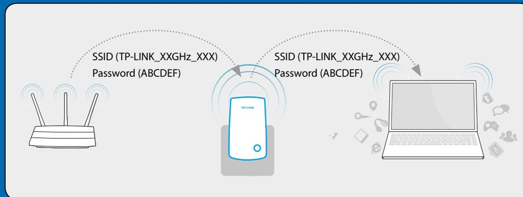
Scegliete il Nome della Rete Wi-Fi del Range Extender (TP-LINK\_XXXXX). Il Range Extender condivide gli stessi Nome di Rete Wi-Fi (SSID) e Password Wi-Fi del vostro Router/AP principale.
