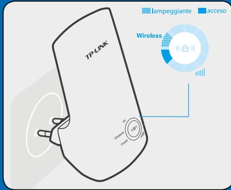
Inserite il Range Extender in una presa elettrica vicina al vostro Router/AP. Attendete fino a che i LED **Power** e **Wireless** si accendano.
