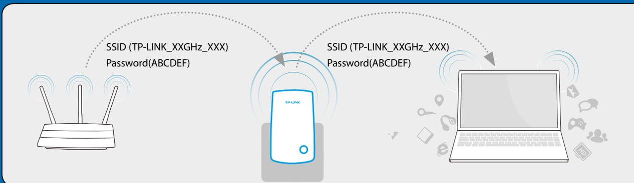
Spostate il Range Extender nel luogo della vostra casa che permette le migliori copertura e qualità di segnale. Il Range Extender si riconnetterà automaticamente al vostro Router/AP principale entro circa 30 secondi dopo che l'avrete alimentato. La collocazione ideale del vostro Range Extender è a metà strada fra il vostro Router/AP principale e i dispositivi Wi-Fi. Se possibile, collocate il vostro Range Extender in un luogo dove la corona LED mostri **3 LED di segnale**.
