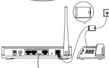
**Nota** Si no requiere de una línea telefónica, por favor conecte el puerto LINE (línea) del Router al enchufe de pared utilizando la línea directamente.
