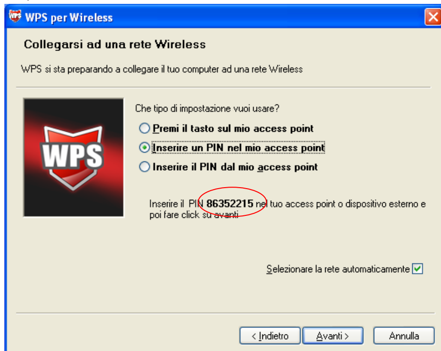
Schermata di configurazione WPS di un client wireless
