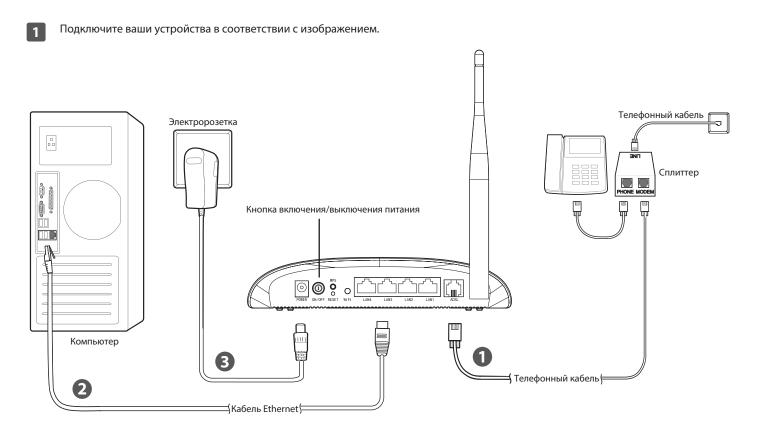
Нажмите кнопку **ON/OFF** (Вкл./Выкл. питание) на вашем маршрутизаторе со встроенным модемом ADSL2+ и убедитесь, что все светодиодные индикаторы (особенно индикатор ADSL) работают, как указано в таблице ниже.
