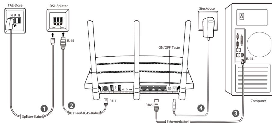
DSL-Anschluss mit Splitter (Standard und Universal)
