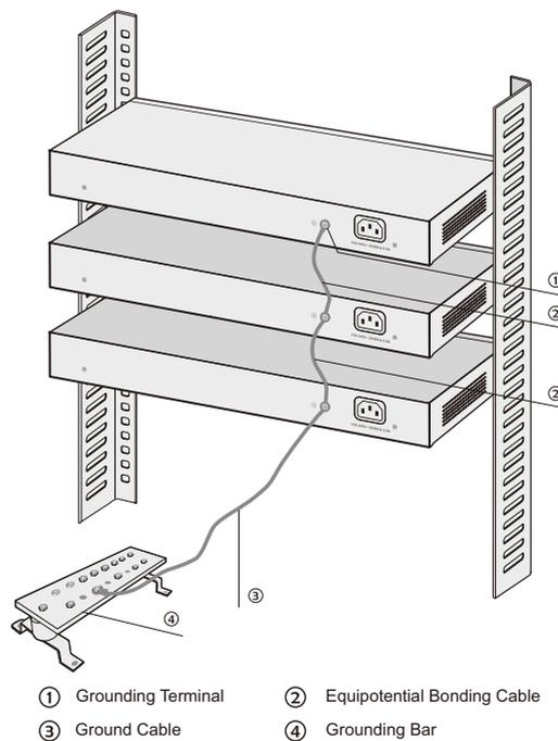
Figure 3-3 Equipotential Bonding
