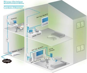
Les adaptateurs doivent être utilisés par paire au moins, le premier adaptateur étant connecté à la source internet, le second dans n'importe quelle pièce alimentée par le même réseau électrique que le premier et à moins de 300m de distance (longueur de câble électrique)
