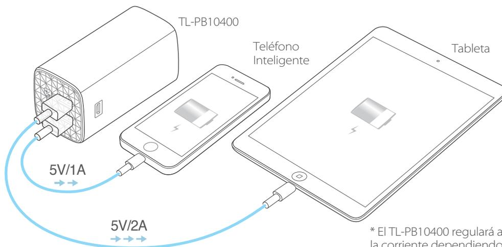
\* El TL-PB10400 regulará automáticamente la corriente dependiendo del tipo de dispositivo conectado.
