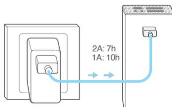
\* El TL-PB10400 es compatible con la mayoría de los adaptadores de 5V DC. Para obtener más eficiencia, te sugerimos utilizar un adaptador de corriente / 2A 5V para cargar el TL-PB10400.
