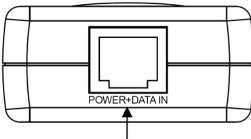
**POWER+DATA IN:** Соедините с PSE-устройством или PoE-инжектором с помощью кабеля CAT5 UTP.
