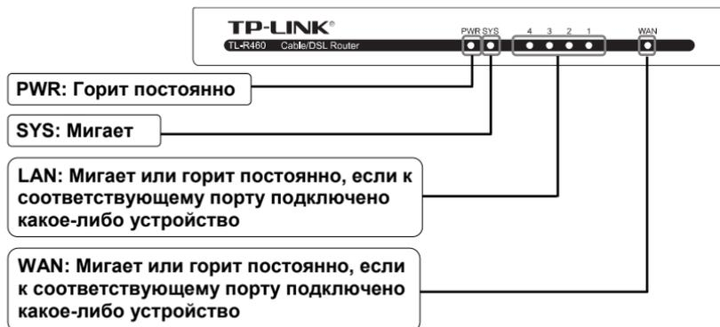
**Внимание** Если индикационные светодиоды LED горят не так, как показано на рисунке, пожалуйста, проверьте правильность подключения проводов к устройству (блок питания и сетевой кабель Ethernet).
