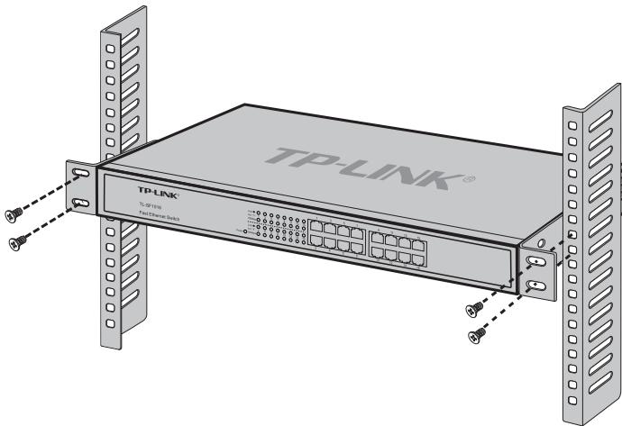
Figura 1-2 Sujeción del Switch al Rack
