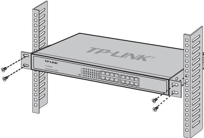
Figura 1-2 Aparafuse o Switch ao bastidor
