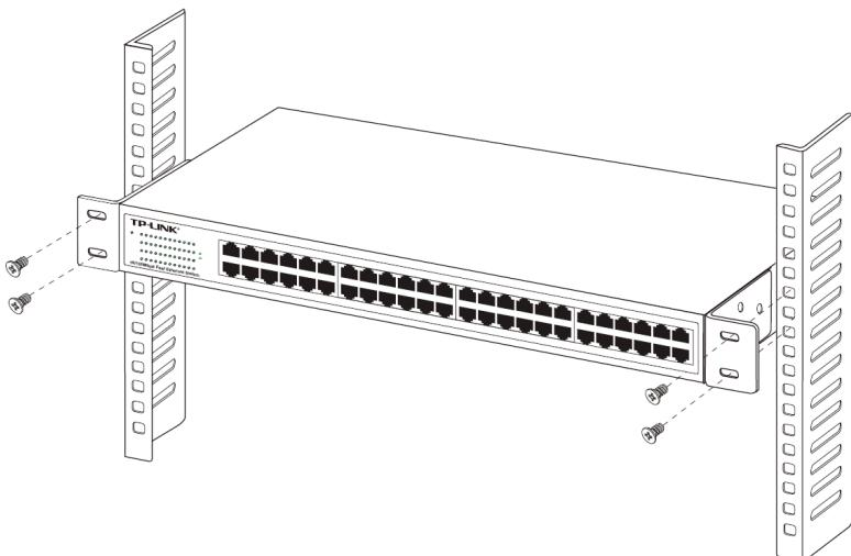
Εικόνα 2-2 Στερέωση του Switch στη βάση
