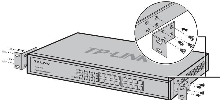
und befestigen Sie alles anschließend mit Schrauben an dem Regal.
