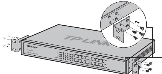
Figuur 1-1 Bevestig de L-haken aan de switch
