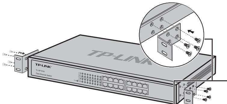
Figura 1-1 Fixe as barras em forma de “L” ao Switch
