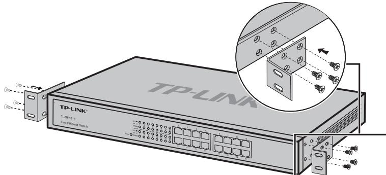
Figura 1-1 Remache de los soportes “L” en el Switch
