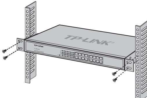
Figuur 1-2 Bevestig de switch in het rack
