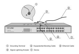
Figure 3-4 Equipotential Bonding
