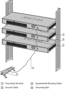
Figure 3-3 Equipotential Bonding
