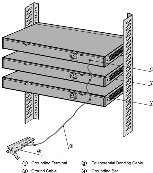
Figure 3-3 Equipotential Bonding
