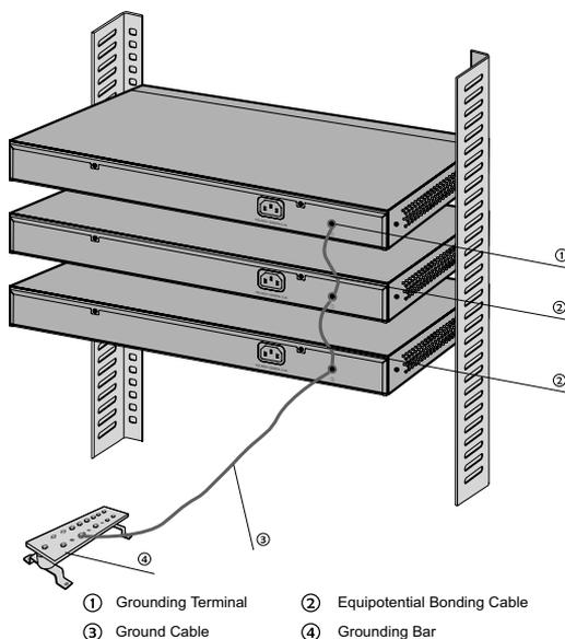
Figure 3-3 Equipotential Bonding
