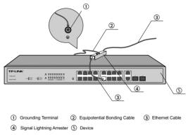
Figure 3-4 Equipotential Bonding
