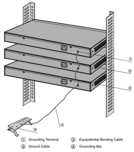
Figure 3-3 Equipotential Bonding
