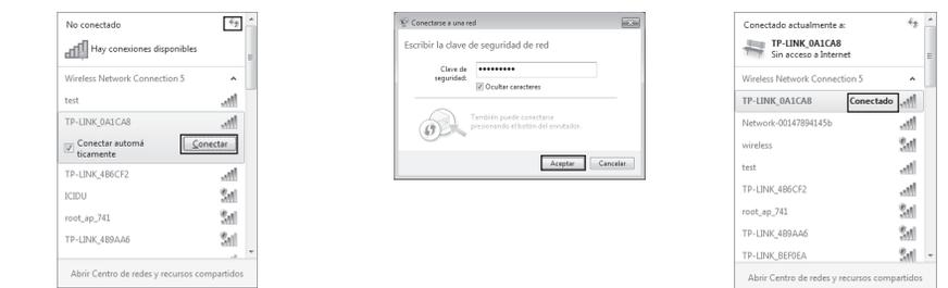
1. El SSID predeterminado de la red es **TP-LINK\_XXXXXX**. (El **TP-LINK\_XXXXXX** es el SSID de la etiqueta.)
