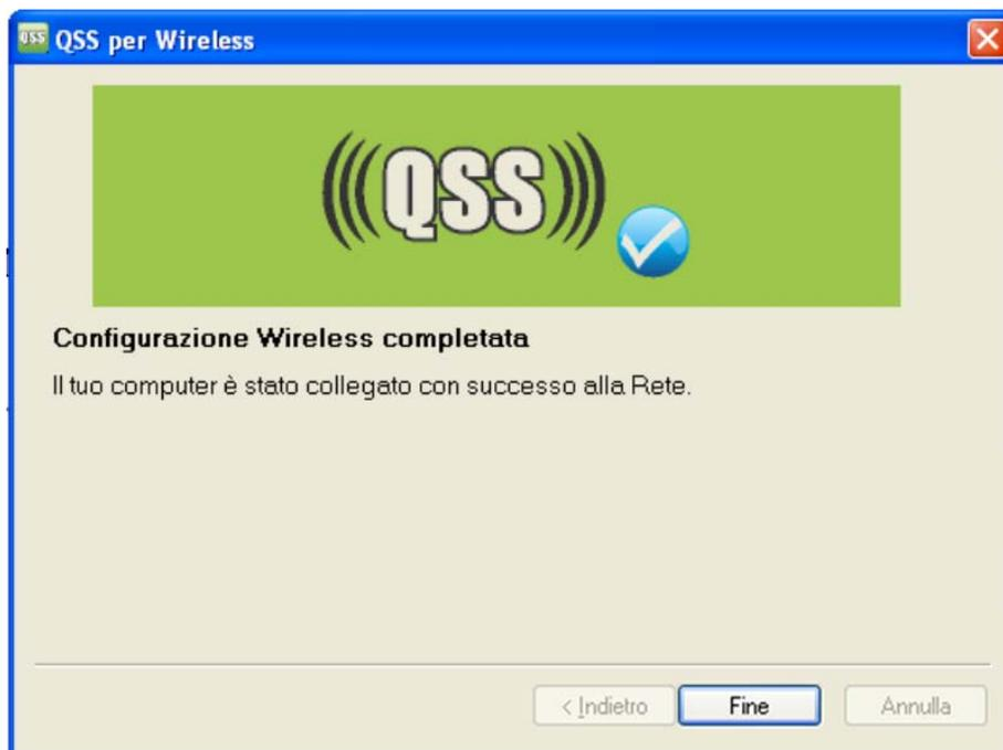
Schermata di configurazione QSS di un adattatore wireless
